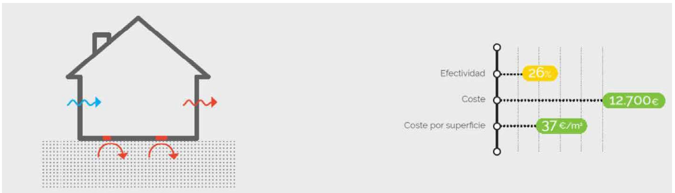
A2+B3: Sellado + Despresurización con red de tubos
