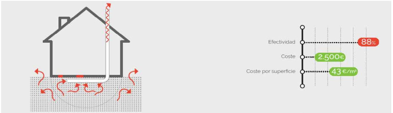
A2+B3: Sellado + Despresurización con red de tubos
